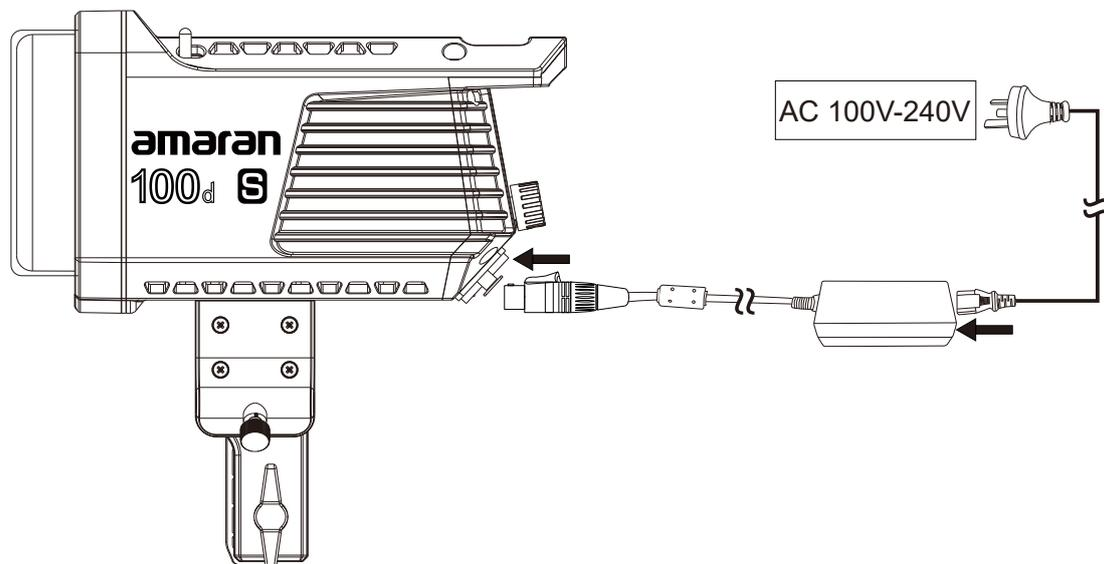
\*将电源线从灯体上拆卸时，请先按下DC接口上的按钮再拆卸，切勿硬拔。
