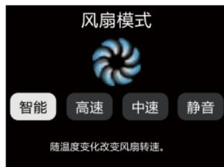
\*静音模式:灯体和灯控的风扇都关闭,最大输出功率调整为100W。
